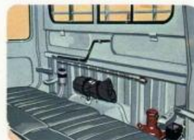
シートバック裏に工具類一式が格納されていて取出しも容易です。
